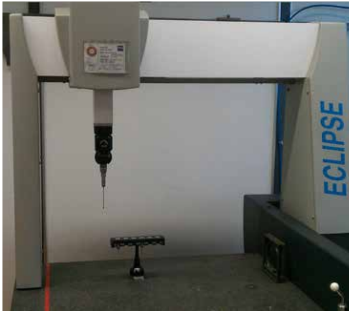
3-D-Messmaschine zur exakten Teilvermessung
