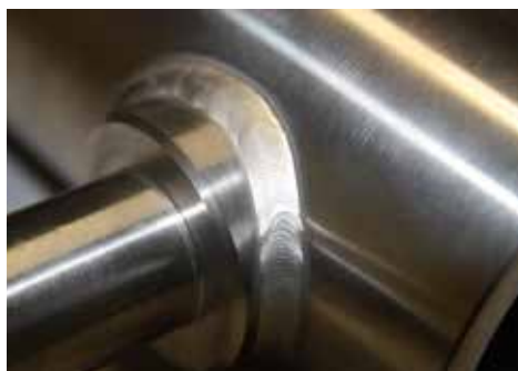
Roboterschweißung Edelstahlteil-Bauteil mit hohen optischen Anforderungen
