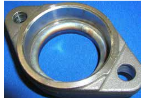
Auftragsschweißung mit hoher Genauigkeit Toleranz des Innendurchmessers im Schweißzustand: 0 / +0,4mm
