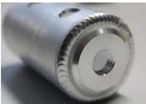
Dichtschweißung an Aluminium-Behälter
