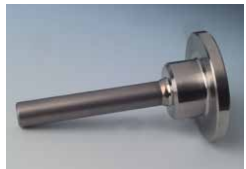
Hochkohlenstoffhaltiger Werkstoff an Nickel Basis-Werkstoff, extrem rissanfällig!
