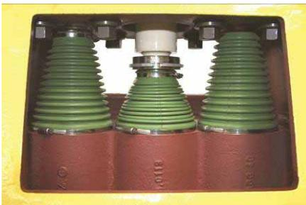
Der Faltenbalg besteht in der Standardausführung aus Werkstoff FKM. Für Spezialanwendungen sind Faltenbälge aus H-NBR und PTFE verfügbar.
