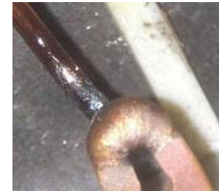
Plasmaschweißung eines Kupferlackdrahtes an eine Anschlussfahne
