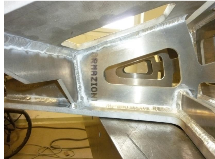
Bild oben/ links: Aluminium – Konsole für Roboter - Greifer
