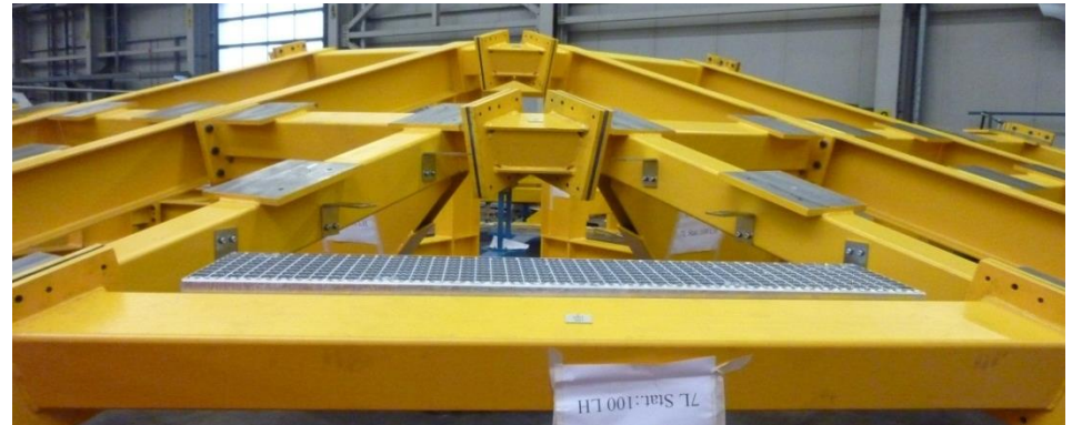
Bild oben: Drehtisch für eine Fertigungs – Straße Bild unten: FE – Ergebnis eines Roboter - Greifers
