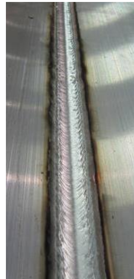
Längsnaht mit dem MIG-Doppelgasprozess geschweißt
