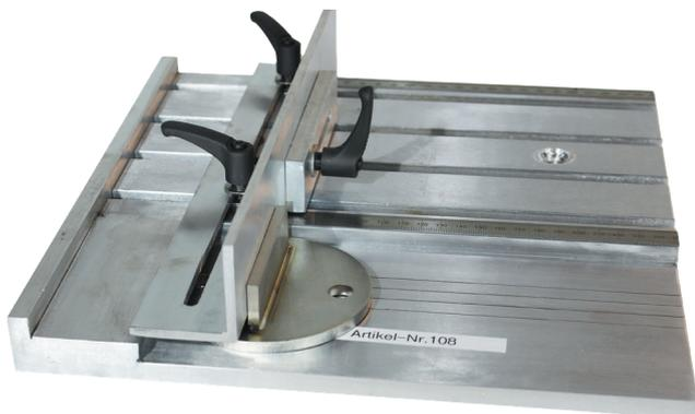
Damit lässt sich an den Steg z.B. eines Rundpfostens eine zentrierte Fußplatte anschweißen. Fußplattengrößen von 10 - 300mm können mit 90° oder jedem beliebigen Winkel mit Anschlag an der Fußplatte verschweißt werden. Als Fußplatten können eckige, runde oder ovale Platten verwendet werden.
