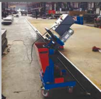
SMUSSO SU LAMIERA L= 12000 mm BEVEL ON METAL SHEET 12000 mm LONG
