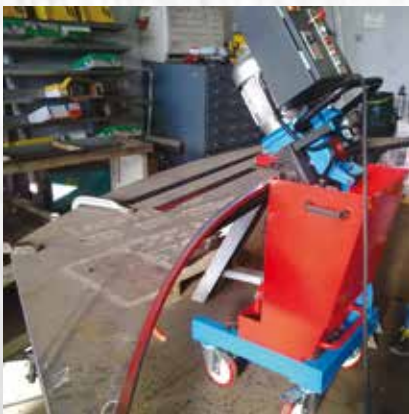
SMUSSO SU RAGGIO INTERNO 3000 mm BEVEL ON INTERNAL RAY OF 3000 mm
