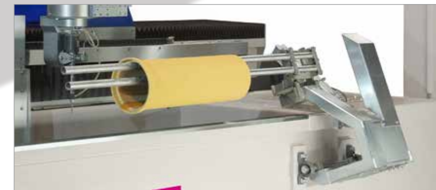
rechts: ausgefahrne Schwenkeinheit für komfortable Bestückung außerhalb des Schneidbeckens.
