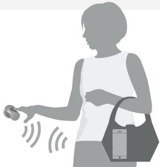
Der Verbindungsaufbau zwischen Smartphone und Zylinder erfolgt durch drehen des Knaufs. Somit wird eine unabsichtliche Öffnung vermieden und die Batterie geschont.
