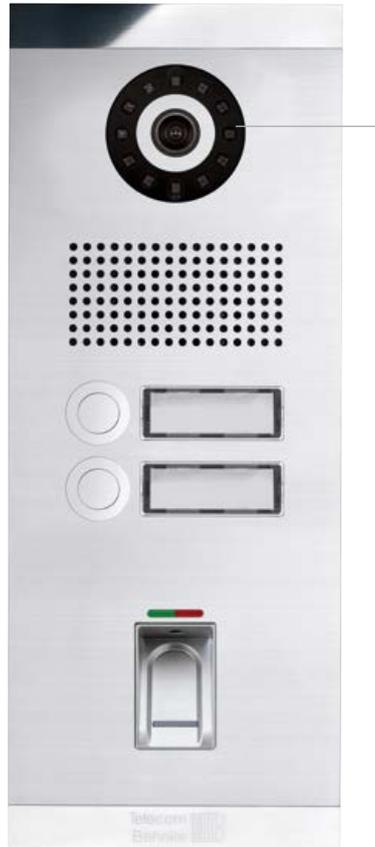
**D** Die Behnke Weitwinkel IP-Kamera überzeugt durch ihren Öffnungswinkel von horizontal 180° und vertikal 90°. Die Kameras sind u.a. mit Beleuchtungsringen (IR-LEDs) ausgestattet und liefern dank automatischer IR-Cut-Filterung Tag und Nacht einwandfreie Bilder.
