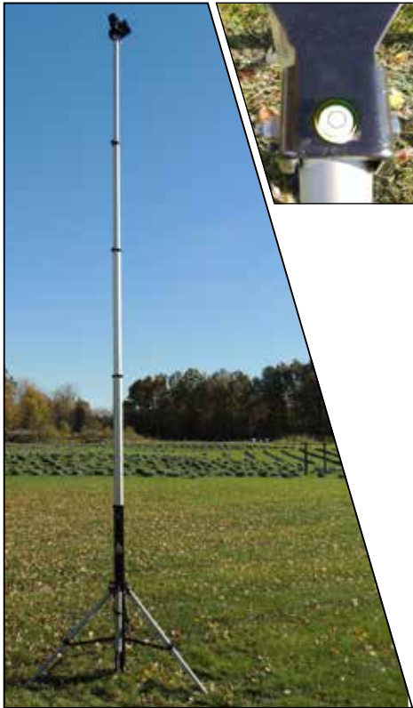
Dreibein mit Wasserwaage
