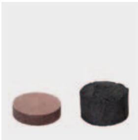
Intumeszenzwirkung Baustoff ZZ-Brandschutzschaum BDS-N minimal
