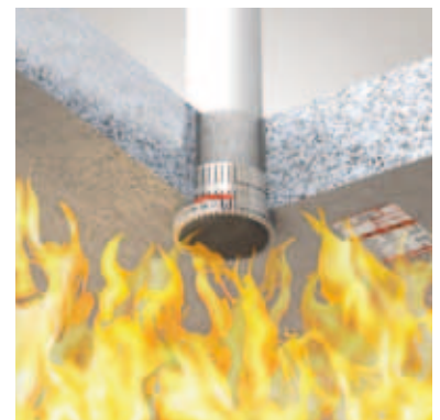
Das Rohr brennt vollständig ab, die Rohrmanschette sowie Rohröffnung sind völlig verschlossen. Eine Übertragung von Feuer und Rauch wird entsprechend der Feuerwiderstandsdauer von 90 Minuten bzw. 120 Minuten verhindert.
