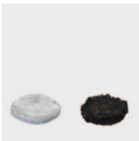
Intumeszenzwirkung Baustoff ZZ-Brand- schutzsilikon NE
