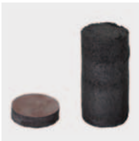
Intumeszenzwirkung Baustoff ZZ-Brand- schutzschaum BDS-N maximal
