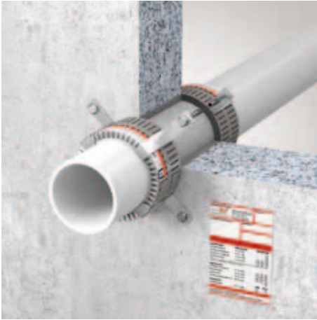
System ZZ-Manschette in Massivwand aufgeschraubt, für den nachträglichen Einbau mit Befestigungsset
