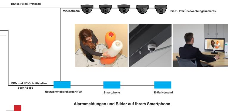
Über optional anschließbare Netzwerkrecorder werden Nachrichten auf Smartphones und Computer versendet. Im Alarmfall erfolgt eine Alarmierung per E-Mail oder SMS. Von jedem beliebigen Ort können Sie die dazugehörigen Videobilder einsehen und entscheiden, welche Schritte Sie einleiten. Unabhängig von einem Alarm besteht jederzeit die Möglichkeit, die Ausstellungsstücke per Smartphone oder Computer zu kontrollieren.
