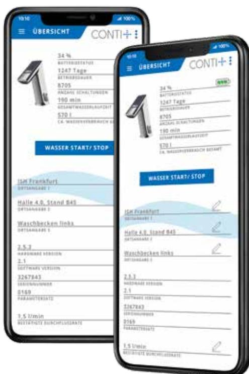
CONTI+ Service APP – ermöglicht einen direkten kabellosen Zugriff auf jede Armatur, die über einen BLE-Knoten verfügt. Somit ist die Einstellung und Überprüfung von Parametern, Aktivierung bzw. Deaktivierung von Service- und Hygienefunktionen sowie das Auslesen von Statusinformationen und statistischen Betriebsdaten einfach möglich. Die Nutzung der Service APP in gewerblichen, öffentlichen und halböffentlichen Bereichen wird durch die CONTI+ Lizenzverwaltung vor unbefugten Zugriffen geschützt.
