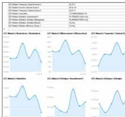
Für die Inbetriebnahme, aber auch für Service und Betrieb steht die professionelle PC-Software „Luftmeister-Tool“ zur Verfügung. Hiermit werden alle Ein- und Ausgänge parametrisiert, Loggerwerte über das Austauschformat CSV nach Excel ausgelesen und die Fehler-, Zähler-, und Justage-Logbücher dargestellt.
