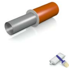
Kleineres Rohr in den Gummiadapter schieben.
