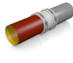
Kupplung mittig über beide Spitzenden schieben und Schösser wechselseitig anziehen.
