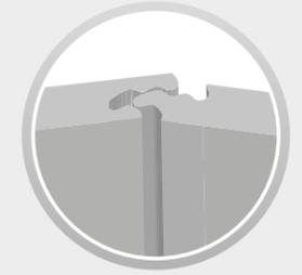
Unsere Hydrolock®-Verbindung bildet eine diskrete, wasserdichte Fuge, ohne den Einsatz von Profilen. Die Paneele mit Hydrolock®-Verbindung können auch sehr gut auf unebenen Wandflächen eingesetzt werden.
