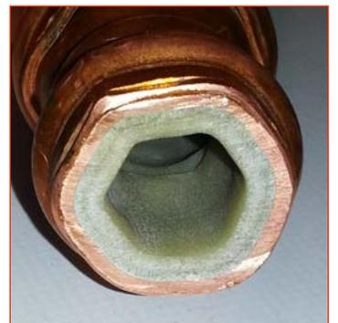
Kupferrohr mit Kalkschicht
