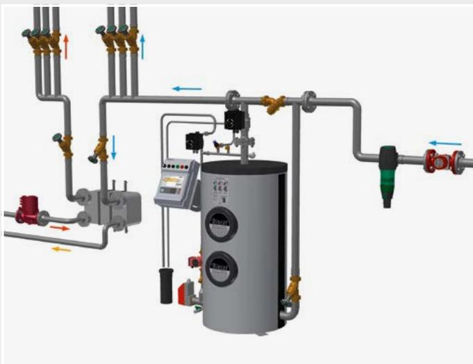
schematische Darstellung einer Trinkwasser-Installation mit BIOCAT KS 14000
