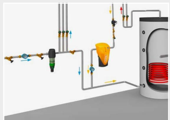
horizontaler Einbau eines BIOCAT WS 1
