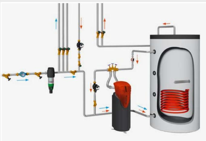
Warmwasser-Installation mit BIOCAT WS 6 und Warmwasserspeicher
