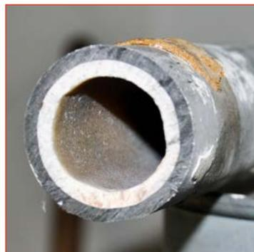
verzinktes Rohr mit Kalkschicht
