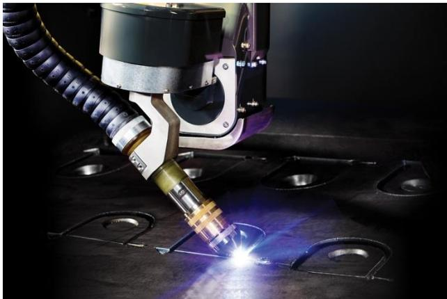
**DMX** Das verlässliche und akkurate Plasma-Fasenschneidsystem von ESAB. Das DMX ist nicht nur einfach in der Nutzung, sondern aufgrund des exklusiven DMX-Bewegungssystems (Direct Multi-Axis) und der Mehrpunkt-Kollisionserkennung von ESAB auch einfach in der Wartung. Dadurch besitzt das DMX weniger Bestandteile und setzt sich nach einer Kollision automatisch zurück,
