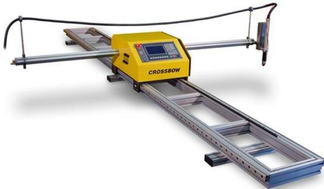
**Crossbow** Diese Maschine lässt sich aufgrund ihres geringen Gewichts einfach transportieren und eignet sich ideal für den Einsatz in Werkstätten, Berufsschulen und für den mobilen Einsatz in großen Anlagen und auf Baustellen. Das präzise Führungssystem der Crossbow ermöglicht eine stabile
