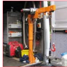
Hummel GSK 500 mit elektrischer Seilwinde in der 90° Position
