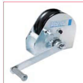
Manuelle, verzinkte Qualitätsseilwinde mit automatischer Lastdruckbremse, stabiler Kurbel und Stahlseil 6,5m x 6mm mit Sicherheitshaken.
