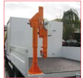
Hummel GSK 500 mit manueller Seilwinde in der Transportposition
