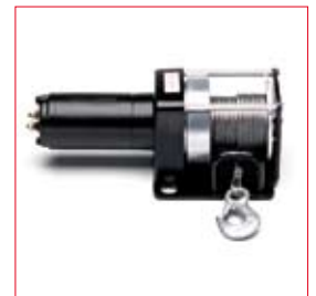
Elektrische Seilwinde in 12V oder 24V mit separatem Relaiskasten, Kabelfernbedienung mit 3m Kabel, Batterieanschlusskabel, Bimetallsicherung und Stahlseil 7,6m x 5mm mit Sicherheitshaken.
