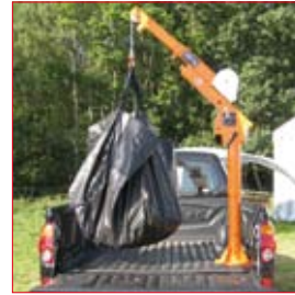
Hummel GSK 500 mit manueller Seilwinde in der 45° Position
