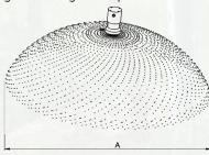
Je nach Einsatzbereich kann die Spritzbreite eingestellt werden und die Sprühsysteme können mit einer oder mehreren Düsen genau an die gewünschte Arbeitsbreite angepasst werden.
