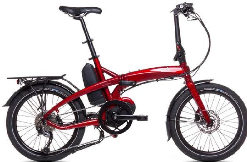
Zwei Varianten kommen 2018 auf den Markt: Beim Tern Vektron D7i ist die Nexus 7-Gang Nabenschaltung verbaut, das Vektron P9 glänzt mit einer Shimano 9-Gang Kettenschaltung. Mit Bafang M400 Max Drive Mittelmotor und knapp 420Wh-Akku bieten beide neuen Vektrons ein unschlagbares Preis-Leistungsverhältnis: viel Funktionalität zum Preis von 2.599,90 €
